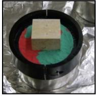
(d) Placing guide rods and modeling clay on the lower ring
