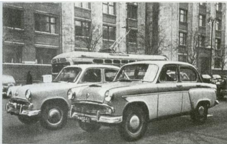
Малолитражный автомобиль «Москвич» модели 1958 года скоро появится на дорогах страны. Он оснащен двигателем с верхним расположением клапанов мощностью сорок пять лошадиных сил. Сочетание двух измененных агрегатов — мотора и заднего моста — сделает «Москвич» более долговечным. Изменяется внешняя и внутренняя отделка машины. Начало массового производства нового «Москвича» намечается на вторую половину этого года.
